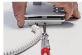
Abb. 3 Gleichzeitig Gehäusefront anheben und vom Unterteil entfernen.
