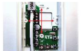
Abb. 4 Die Innensprechstelle kann nun wahlweise auf eine Schallerdose oder plan an der Wand montiert werden (Befestigungsmaterial nicht im Lieferumfang).
