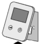
Abb. 2 Ziehen Sie Sprechstelle nun nach oben hin ab und lösen Sie diese von der Grundplatte
